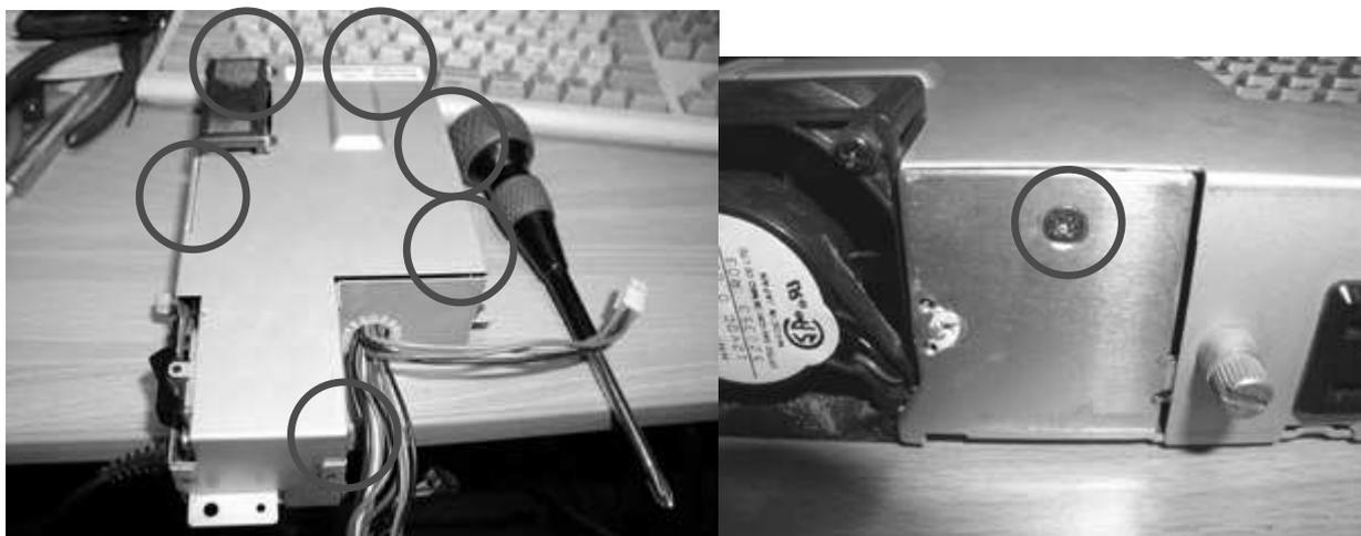
7. 電源装置を本体から取り外す事ができたら電源ケースのカバーを取り外します。○印のところにあるネジを取り外します。アルミシャシの部分の皿ネジはファンから遠い方のネジを取り外して下さい。
