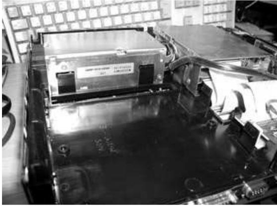
6. 拡張スロットが外れたら電源装置も同じ要領で取り外します。
