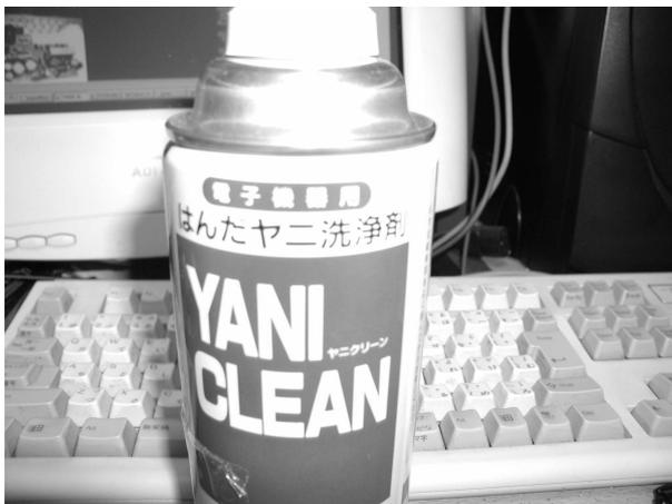
13. 基板を取り外す事ができたら埃や電解コンデンサから洩れて付着している電解液などを洗い流します。洗浄剤でオススメなのがSunhayatoの『ヤニクリーン』です。この段階での洗浄は電解コンデンサを外す前の予備洗浄ですので、ざっとで構いません。電解液などは水溶性なのですぐに洗い流す事ができます。洗浄作業をする際にはウエスや不要になったタオルなどを下に敷いて廃液を吸わせるようにして下さい。
