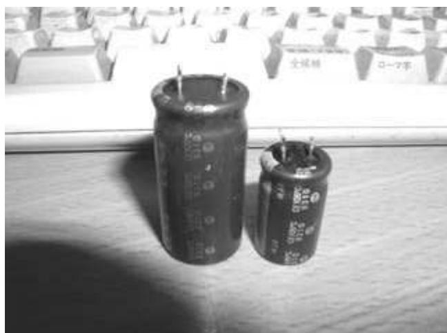
X680x0 電源装置で採用されている ELNA のアルミ電解コンデンサは ACE 前期付近の時期に問題のある4級塩使用の Longlife 電解コンデンサになったもよう。ロットナンバーが9210以前は未対策らしいが、対策されたとされる時期の9310でも電解液洩れが発生しているものを確認。結局のところ4級塩使用のアルミ電解コンデンサは全滅らしい。
