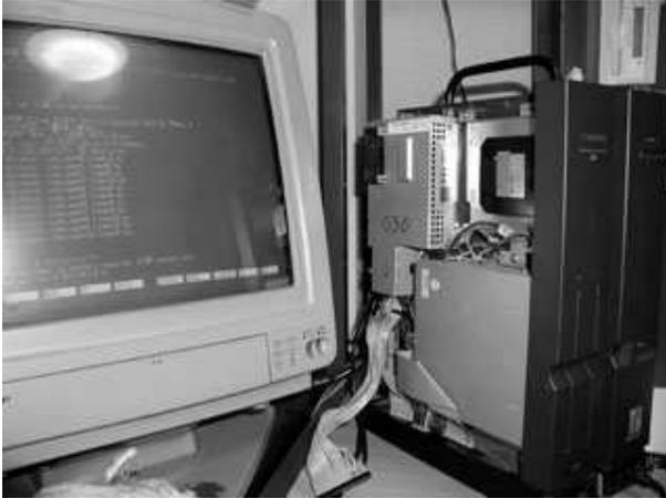
25. 電源装置を取り外した時と逆の手順で取り付けて正常に動作すれば完了です。お疲れ様でした。
