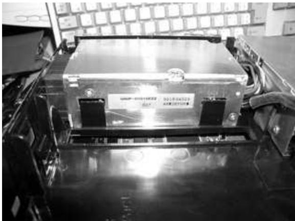
14. 電源装置を本体に戻します。この時、電源コネクタを差し込むのを忘れない様に注意しましょう。また電源コネクタのロックがきちんと掛かるように『カチッ』という音がするまで確実に差し込んで下さい。Compactの各ユニットを固定しているのはプラスチックの爪なので、この爪に無理な力が掛からないように上から真っ直ぐに差し込むように注意しましょう。
