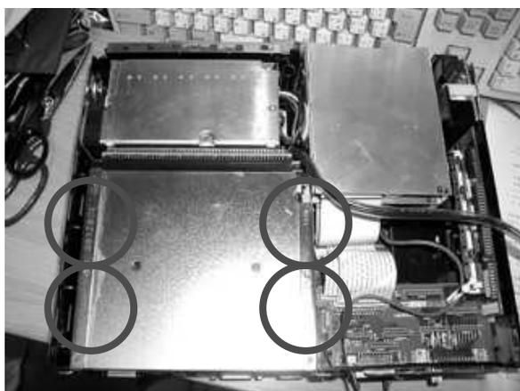
4. シールド板を外すと各ユニットが現れます。まずは拡張スロットを取り外しましょう。○のところのプラスチックの爪で固定されていますので爪のロックを解除しながら真上に引き抜きます。
