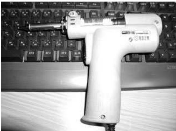
14. 電解コンデンサを取り外します。この時写真のような自動ハンダ吸取り器があると、とても便利で作業も手早く行えます。写真のものはgootのTP-100です。温度調節ダイヤル付きでバキュームも強力なのでスルーホールも一発です。
