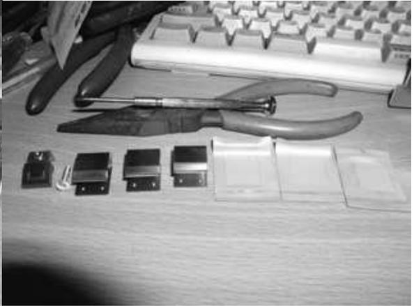
11. レギュレータなどのところに付いているクリップを外します。熱伝導シートを挟んで電源装置のシャシに密接させる為にかなりキツく取り付けられていますので、太めの精密ドライバなどをシャシとクリップの間に差し込んでシャシの端の部分でテコにして少し浮かせ、そこにラジオペンチなどを差し込んで掴みながら持ち上げると簡単に取り外す事ができます。このクリップは全部で3個ありますので、同じ要領で取り外して下さい。
