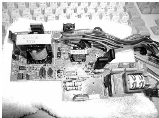
電解液の悪影響は他にもあります。銅を腐食させ、導電性を失わせたり、リードを腐食したり、金属皮膜の抵抗の被覆を腐食してしまったり、トランスに飛び散ると非常に高い電圧でショートが発生する事になるので、とても深刻です。ですから電源装置内で飛び散った電解液を取り去る事は非常に重要であり、ヤニクリーンを多めに使ってクリーンアップする事は何も見た目を満足させる為だけではないのです。基板上に導電性のある金属片が張り付いていたら、誰でもそれを取り除くはずですが、導電性のある電解液を放置しておくという事は、同じ導電性のある金属片を多量に撒き散らして放置しているのと同じ事なのです。くれぐれもクリーンアップは確実に行って頂きますように、お願いします。
