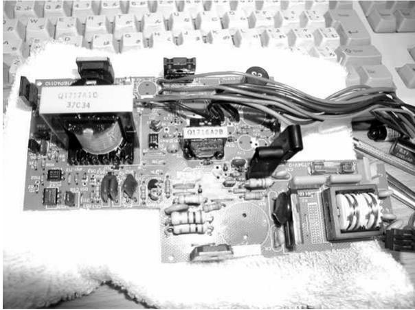
15. 電解コンデンサを全て取り外す事ができたら本洗浄工程に移ります。『ヤニクリーン』を使う場合は最初に少量を全体に吹きかけてしばらく放置して汚れを浮かせてから浮いた汚れを洗い流すようにするとよいでしょう。トランス部、部品実装面、基板のパターン面、それとビア（部品の足が刺さる基板にある穴）も隅々まで洗浄して下さい。特に電解液洩れのあった電源装置は特に念入りに洗浄する必要があります。しつこい汚れの付着がある場合は、
