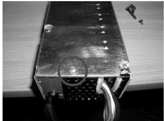
9. 写真○のところのネジを取り外して電源ケースの蓋を外します。
