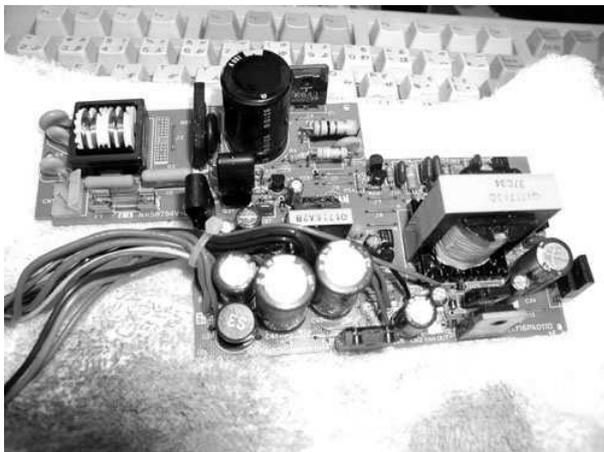
18. 電解コンデンサには極性があります。取り付けた電解コンデンサが極性を正しく取り付けられているか、よく確認して下さい。極性を間違えたまま使用すると破裂や故障の原因となり大変危険ですので注意しましょう。この段階で仕上げの洗浄をするのもよいと思います。使用する電解コンデンサによっては洗浄を嫌うものもありますので、電解コンデンサメーカーのHPなどの情報でよく確認して下さい。また、この段階で部品面やパターン面に金属屑やハンダ屑が残っていないか、目視で良く確認しておきましょう。
