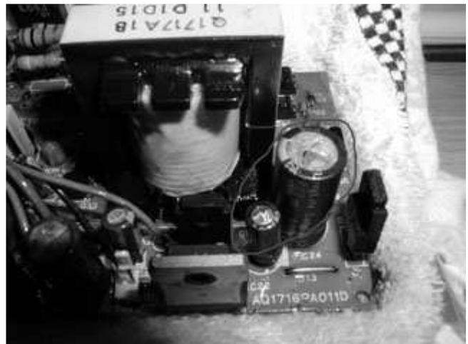
図1：液洩れしている電解コンデンサ
