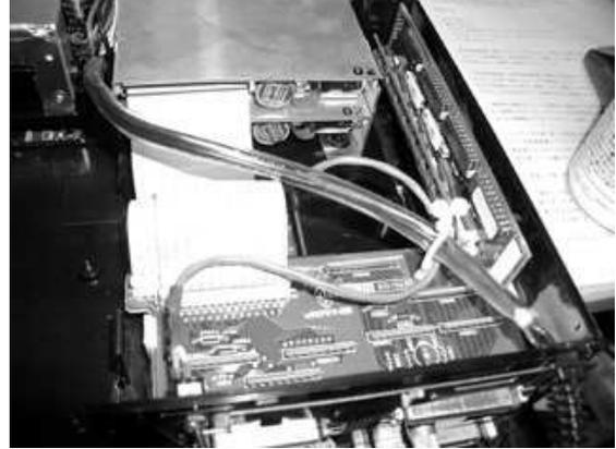
7. 写真は REDZONE なのでクロック切替のスイッチがありますが、通常のモデルではありません。電源ユニットを取り外す際には、右写真のように電源コードを止めている部分がありますので予め取り外して下さい。電源コードが本体から出て行く部分も上に引き上げれば外れます。
