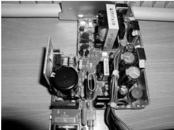
20. シャシや各部の乾燥が終わったら仮組みをして動作確認を行います。右の写真ではクリップなども取り付けていますが、動作確認の際は通電し動作させている時間が短いので放熱用のクリップなどは取り付けなくても大丈夫です。故障のあった電源装置の場合は動作チェックでNGとなる事もありますので、仮組みで動作確認の方が賢明でしょう。仮組みとは言ってもカバーも確実に取り付けて下さい。
