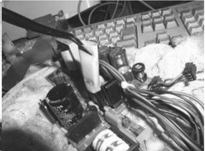
12. ○印の部分4箇所にはネジがありますので緩めて取り外して下さい。ネジを取り外したら基板の写真手前の方を持ってシャシから少し浮かせるようにして手前に引きシャシから基板を取り外して下さい。この時無理な力を掛けずに取り外せるはずですので、どこかに引っ掛かりを感じたら取り外し忘れていたネジやクリップが無いか確認して下さい。Q31に被っている筒状の熱伝導シートも取り外しましょう。
