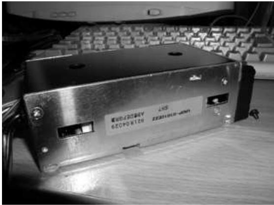
8. 電源コネクタを引き抜き、電源装置を取り外す事ができたらよいよ電源装置の分解です。
